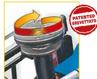
Il bloccaggio centrale, idoneo anche per ruote rovesci, avviene tramite un perno centrale con cono. Lo sforzo è minimo grazie allo speciale piattello di appoggio ruota, di tipo flottante con effetto auto-bloccante.
