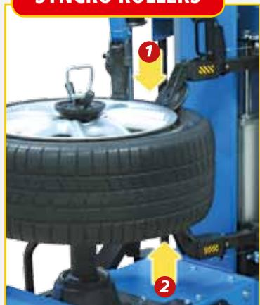
Lo stallonamento viene fatto tramite due rulli con movimento sincronizzato. Lato superiore e inferiore vengono stallonati da due rulli opposti in rapida successione.
